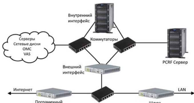
Рис. 6. Схема использования системы DPI для применения политик к сетевому трафику
