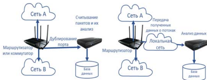
Рис. 7. Различия типичных схем packet (слева) и flow-based (справа) анализа
