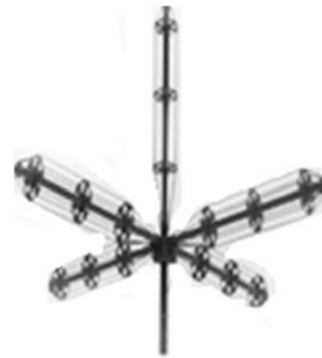
Рис. 2. Активная малогабаритная приемная антенна (АМП) с триортогональными вибраторами
