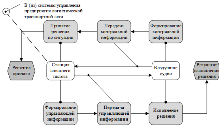
Рис. 1. Функциональная схема процесса передачи управляющей информации в беспилотной авиационной системе
