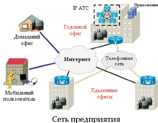
Рис. 1. Пример построения корпоративной сети связи
