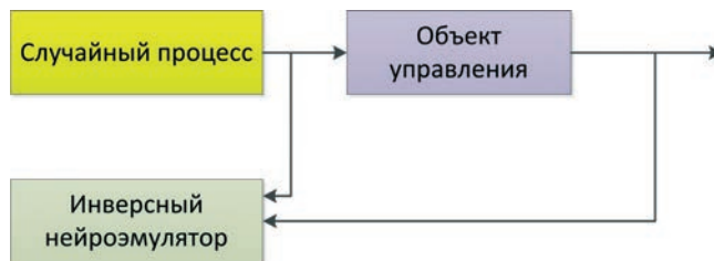
Рис. 2. Обучение нейроконтроллера в схеме обобщенного инверсного управления
