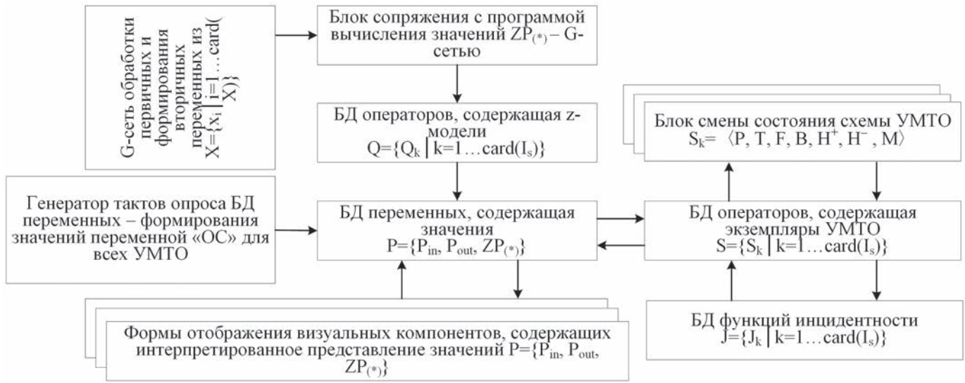
Рис. 6. Схема функционирования ИПС потоковых вычислений. БД – база данных, УМТО – унифицированная модель типовой операции процесса мониторинга
