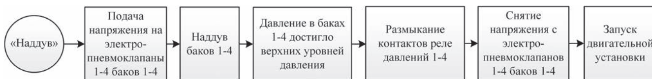
Рис. 3. Схема процесса мониторинга системы наддува баков двигательной установки ракеты-носителя
