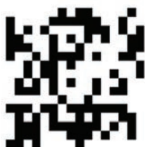
Рис. 5. Извлеченный ЦВЗ при неправильно выбранном генераторе ПСП
