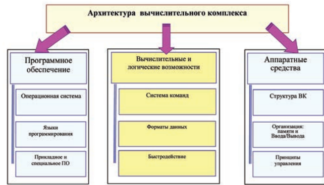
Рис. 1. Упрощенная архитектура вычислительного комплекса
