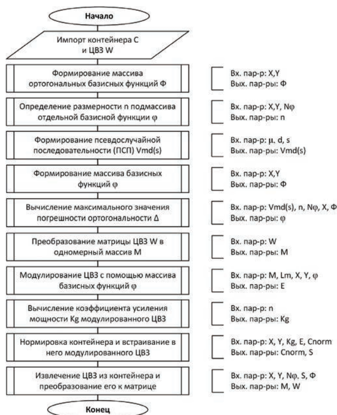
Рис. 1. Блок схема алгоритма встраивания ЦВЗ методом расширения спектра
