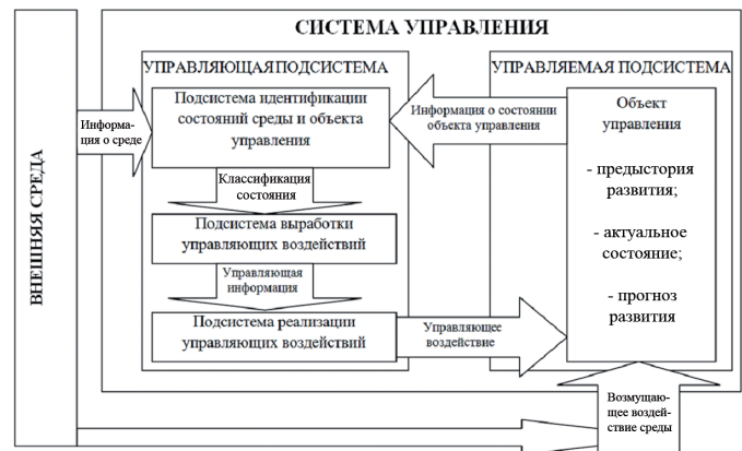
Рис. 2. Типовая структура АСУ
