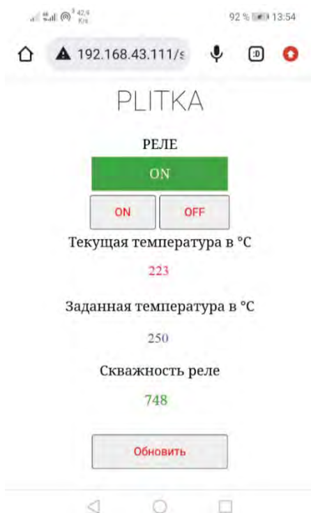
Рис. 8. Экран мобильного приложения для управления работой лабораторной печи
