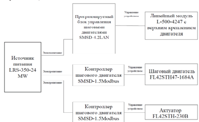
Рис. 12. Схема электропитания и управления системой
