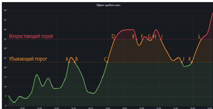
Рис. 2. Применение триггерного механизма для сокращения числа событий вследствие эффекта «дребезга нуля»
