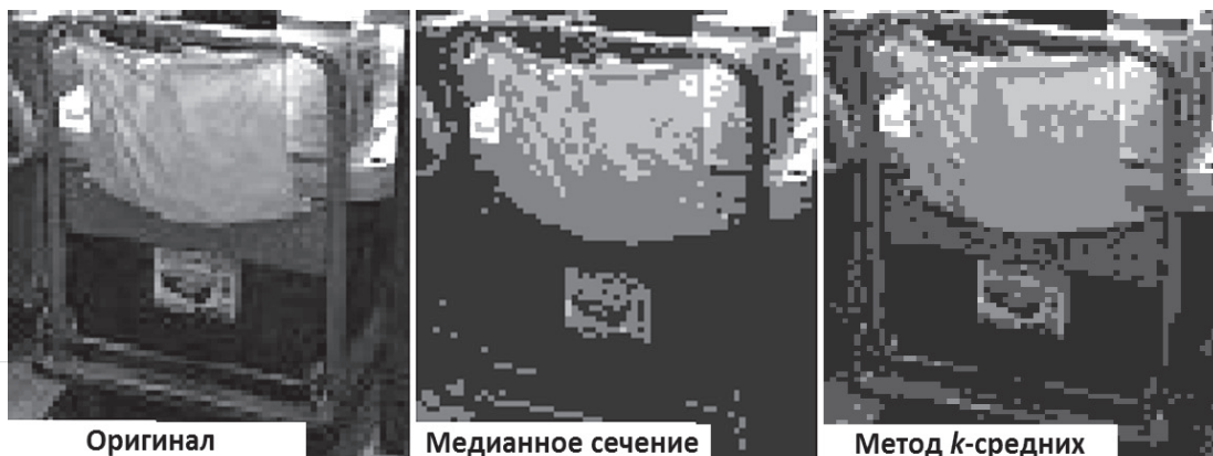
Рис. 1. Пример тоновой аппроксимации на основе различных подходов
