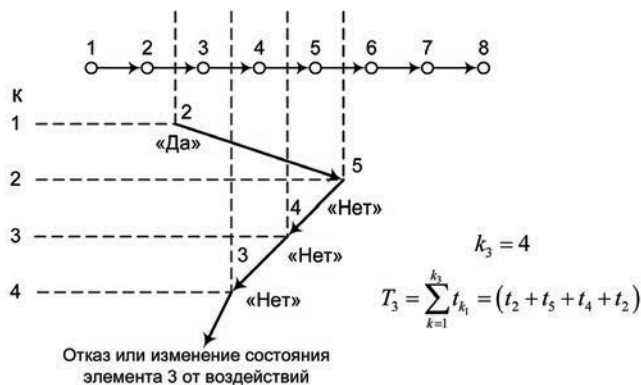
Рис. 2. Схема организации управления в условиях интенсивных воздействий на ИПС
