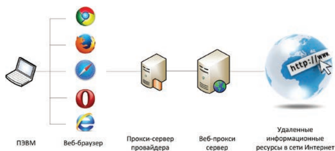
Рис. 4. Классическая схема доступа к удаленным информационным ресурсам с использованием веб-прокси
