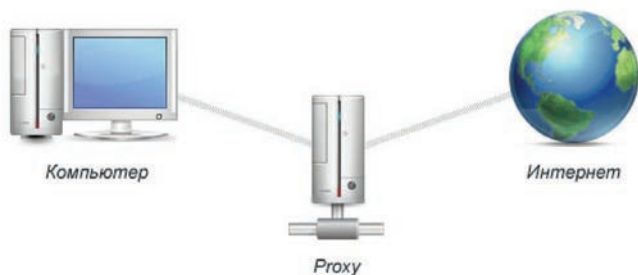
Рис. 1. Схема предоставления доступа к удаленному информационному ресурсу с использованием прокси-сервера
