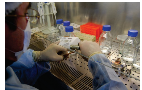
Вскрытие пробоотборника «Тест» в лаборатории в ламинарном шкафу II защиты
