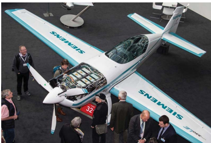
Рис. 2. Самолет Extra-330LE, оснащенный электродвигателем мощностью 260 кВт производства компании Siemens
