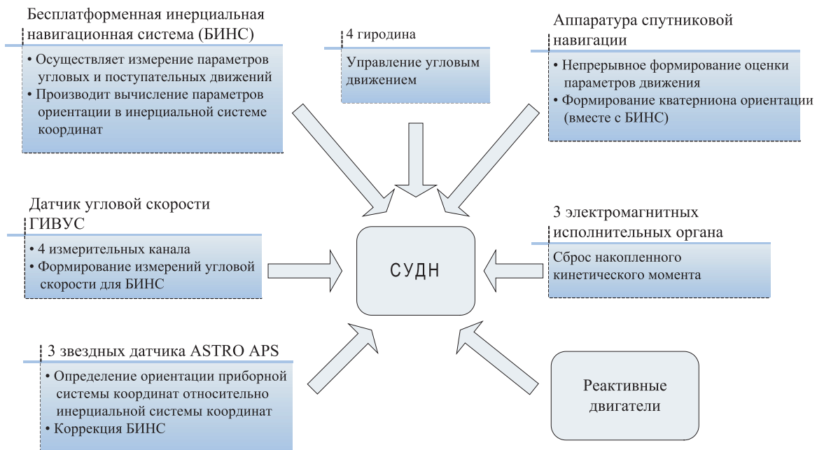
Рис. 1. Приборный состав системы управления движением рассматриваемого космического аппарата
