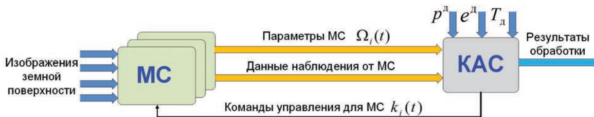
Рис. 4. Схема взаимодействия КАС и МС в кластере МС
