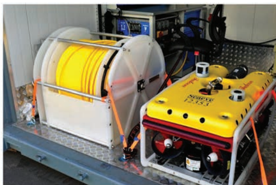
Рис. 4. ТНПА «Фалкон» (слева) и ТНПА «Гном» (справа) с кабелем связи и управления
