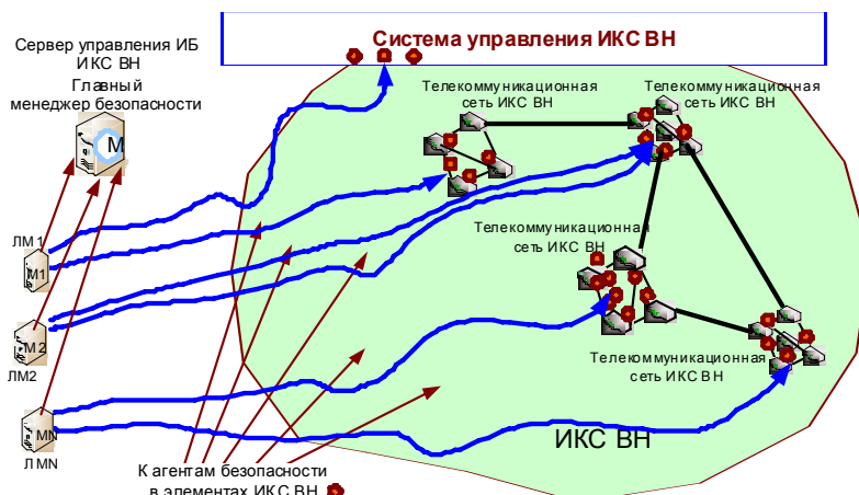
Рис. 1. Архитектура подсистемы управления ИБ ИКС СН
