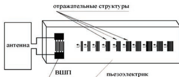
Рис. 8. Конструкция линии задержки на ПАВ с отражательными структурами в виде металлических полосок или канавок
