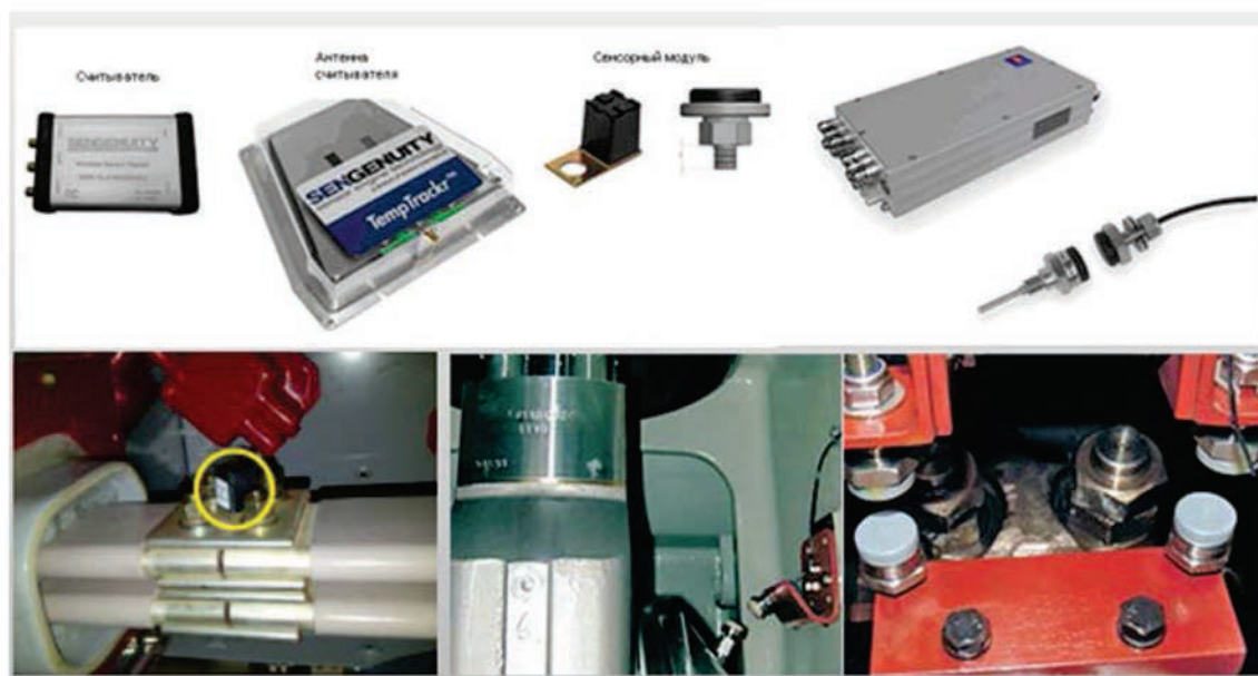
Рис. 9. Элементы беспроводных систем контроля нагрева узлов электрооборудования и мониторинга поршневых машин, а также примеры установки ПАВ-датчиков температуры
