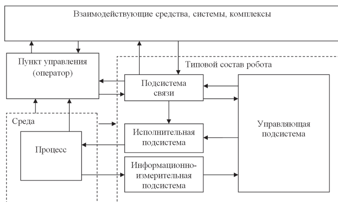
Рис. 6. Структурно-функциональная схема робота
