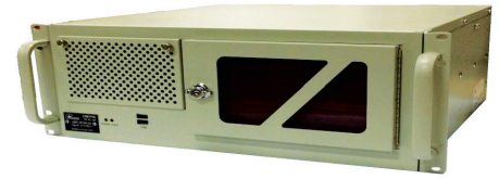
Рисунок 5 – Внешний вид действующего макета многоканального радиоприемного устройства, построенного на SDR-технологиях (в составе аппаратно-программного комплекса)
