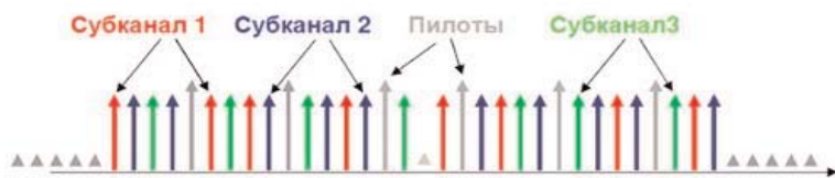
Рис. 2. Субканалы частотного канала WiMax
