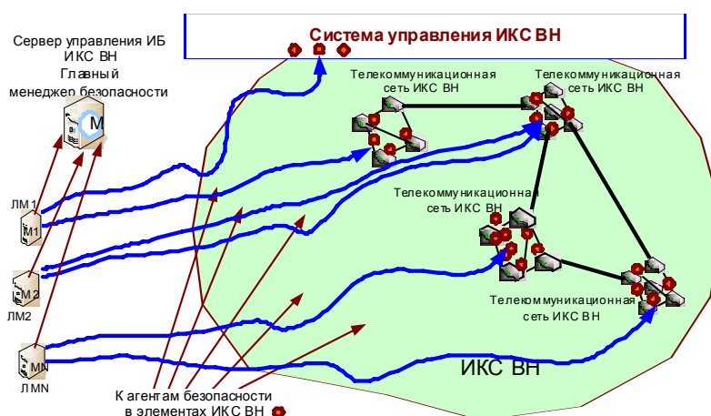
Рис. 2. Архитектура подсистемы управления ИБ ИКС ВН
