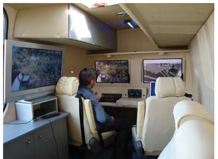
Рис. 9. Пункт управления привязного аэростатического комплекса «Пересвет»
