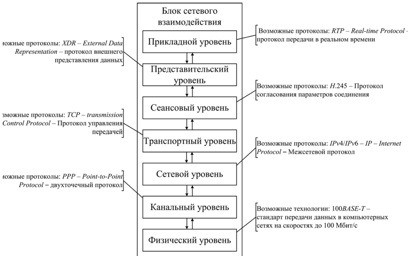
Рис. 4. Логическая структура блока сетевого взаимодействия
