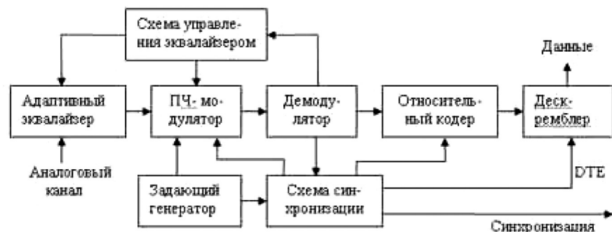
Рис. 3. Схема приемника синхронного модема
