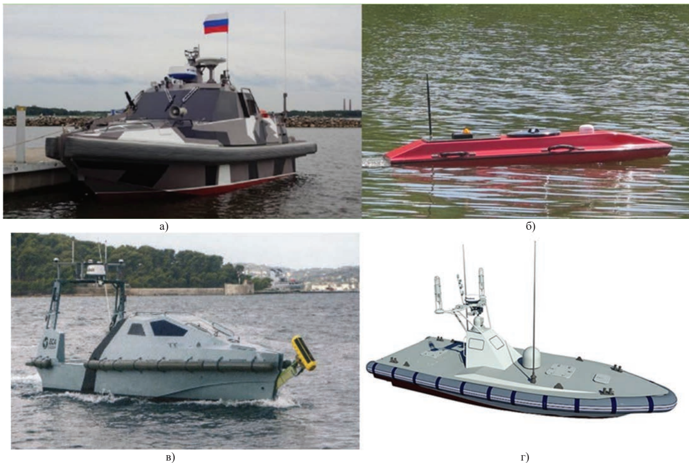
Рис. 2. Виды средств мониторинга: а) и в) на базе БЭВС среднего класса (безэкипажный катер «Искатель», АО «НПП «АМЭ»); б) и г) малого класса с установленным бортовым АИК и его антенно-фидерной подсистемой (проектные решения под конкретные задачи процедур мониторинга СРС и СНО на ВВП РФ)
