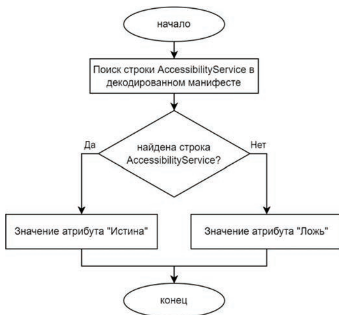
Рис. 6. Блок-схема алгоритма определения значения атрибута В
