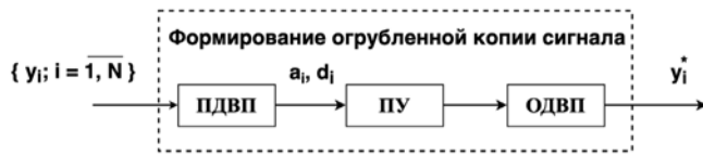
Рис. 5. Структурная схема блока формирования огрубленной копии аудиосигнала
