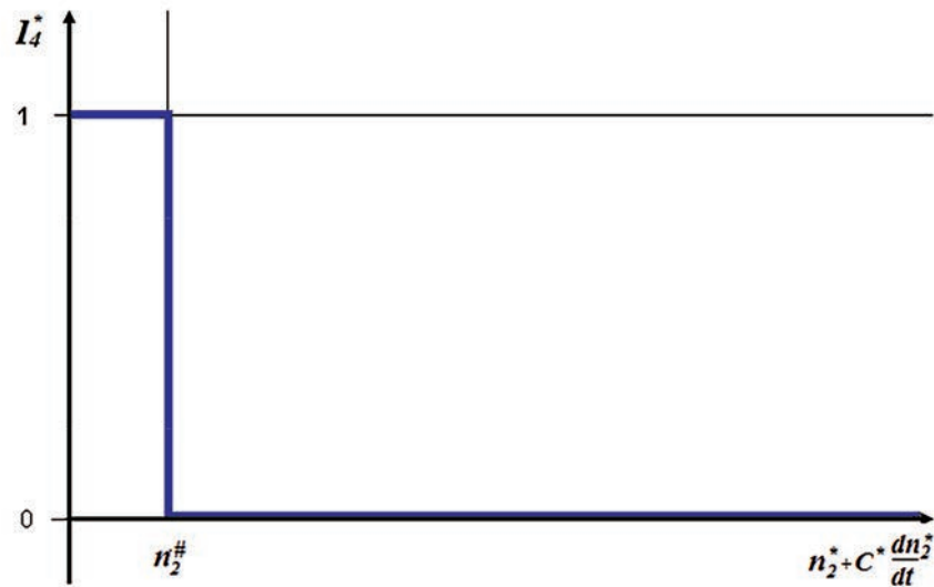
Рис. 7. Изменение значения цифрового сигнала управления I_4^* в зависимости от соотношения контролируемых значений частот вращения роторов турбин компрессоров высокого давления обоих ТРД
