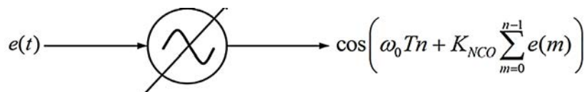
Рис. 2. Принцип функционирования цифрового ГУН
