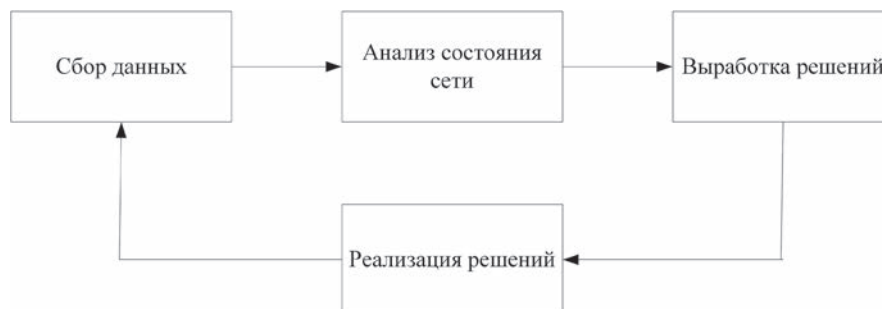
Рис. 5. Цикл технологического управления VLAN
