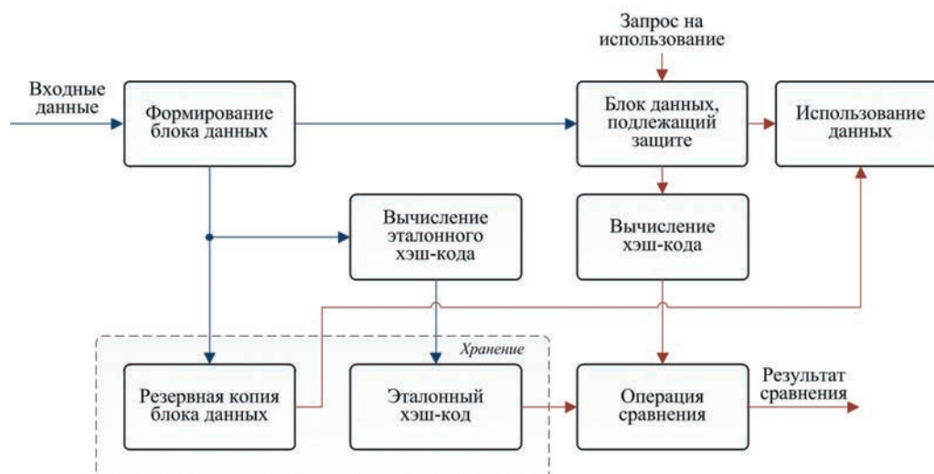
Рис. 1. Схема, поясняющая процедуру криптографического контроля целостности данных с возможностью их восстановления из резервной копии
