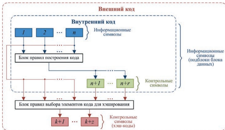
Рис. 4. Общая схема, поясняющая метод контроля и обеспечения целостности данных на основе совместного использования криптографических методов и кодов, контролирующих ошибки
