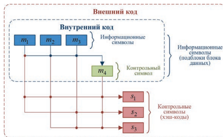
Рис. 5. Схема, поясняющая метод контроля и обеспечения целостности данных (внутренний код – код с проверкой на четность, при построении внешнего кода используется систему линейно независимых векторов для построения (7,4)-кода Хемминга)
