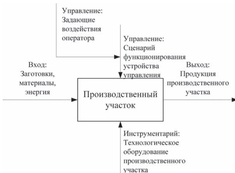
Рис. 4. Обобщенная модель производственного участка в нотациях IDEF0»
