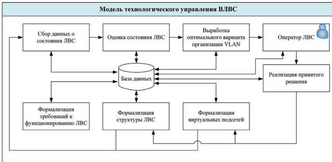
Рис. 6. Модель технологического управления ВЛВС КИС
