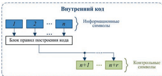
Рис. 3. Схема, поясняющая процедуру построения кодового слова (n+r, n) -кода
