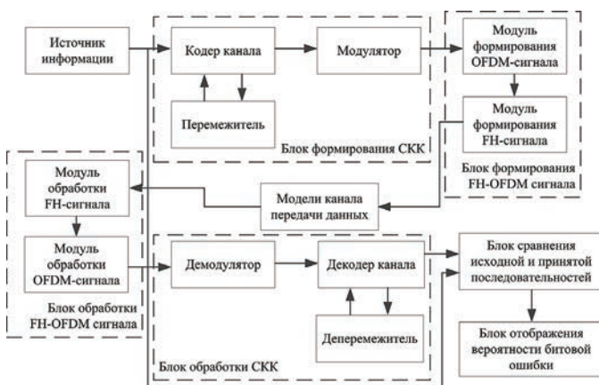
Рис. 1. Структурная схема имитационной модели с блоками формирования и обработки FH-OFDM сигналов
