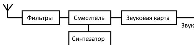
Рис.1. SDR приемник с переносом спектра на низкую частоту
