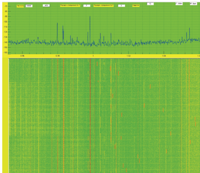
Рис. 4. Масштабированная спектрограмма действующих радиолиний с ППРЧ, полученная с помощью разработанного многоканального РПУ (частотный диапазон РЛ с ППРЧ показан фигурной скобкой)
