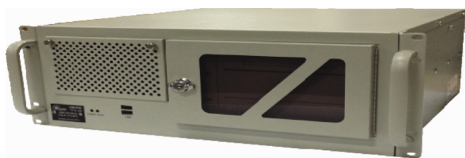
Рис. 2. Внешний вид действующего макета многоканального РПУ (на SDR-технологиях)
