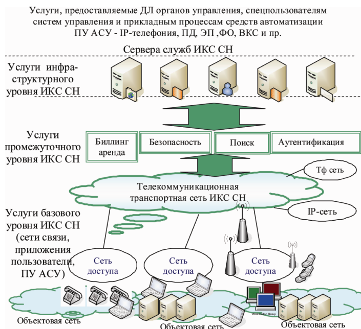
Рис.1. Многоуровневая архитектура современных ИКС СН
