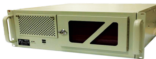
Рисунок 5 – Внешний вид действующего макета многоканального радиоприемного устройства, построенного на SDR-технологиях (в составе аппаратно-программного комплекса)
