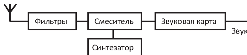
Рисунок 2 – SDR приемник с переносом спектра на низкую частоту
