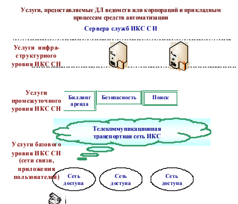
Рис. 1. Архитектура современных ИКС СН
