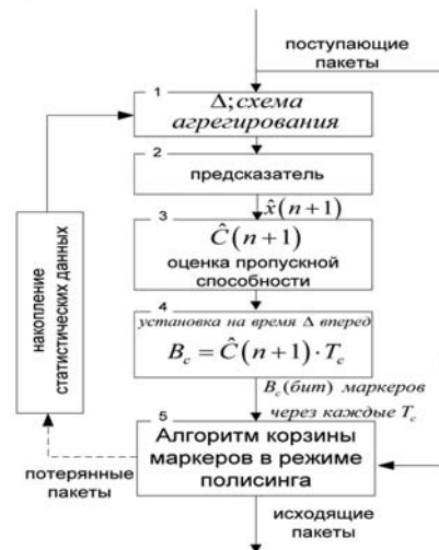
Рис. 3. Принцип работы метода разделения времени передачи пакетов
